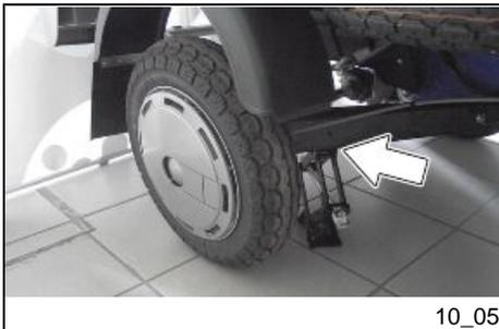
Posizionare il cric sotto al triangolo della sospensione facendo coincidere la nervatura del triangolo con la scanalatura del cric stesso.
