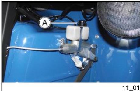
Nel caso in cui il livello risulti inferiore al minimo, rivolgersi ad un **Concessionario o un Punto di Assistenza Autorizzato PIAGGIO** per effettuare un controllo accurato del sistema frenante.
