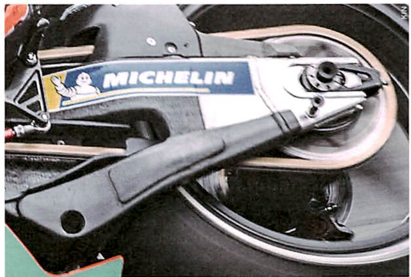
Die bisherige Alu-Schwinge: Steifer an der Schweißnaht vor dem Kettenspanner
