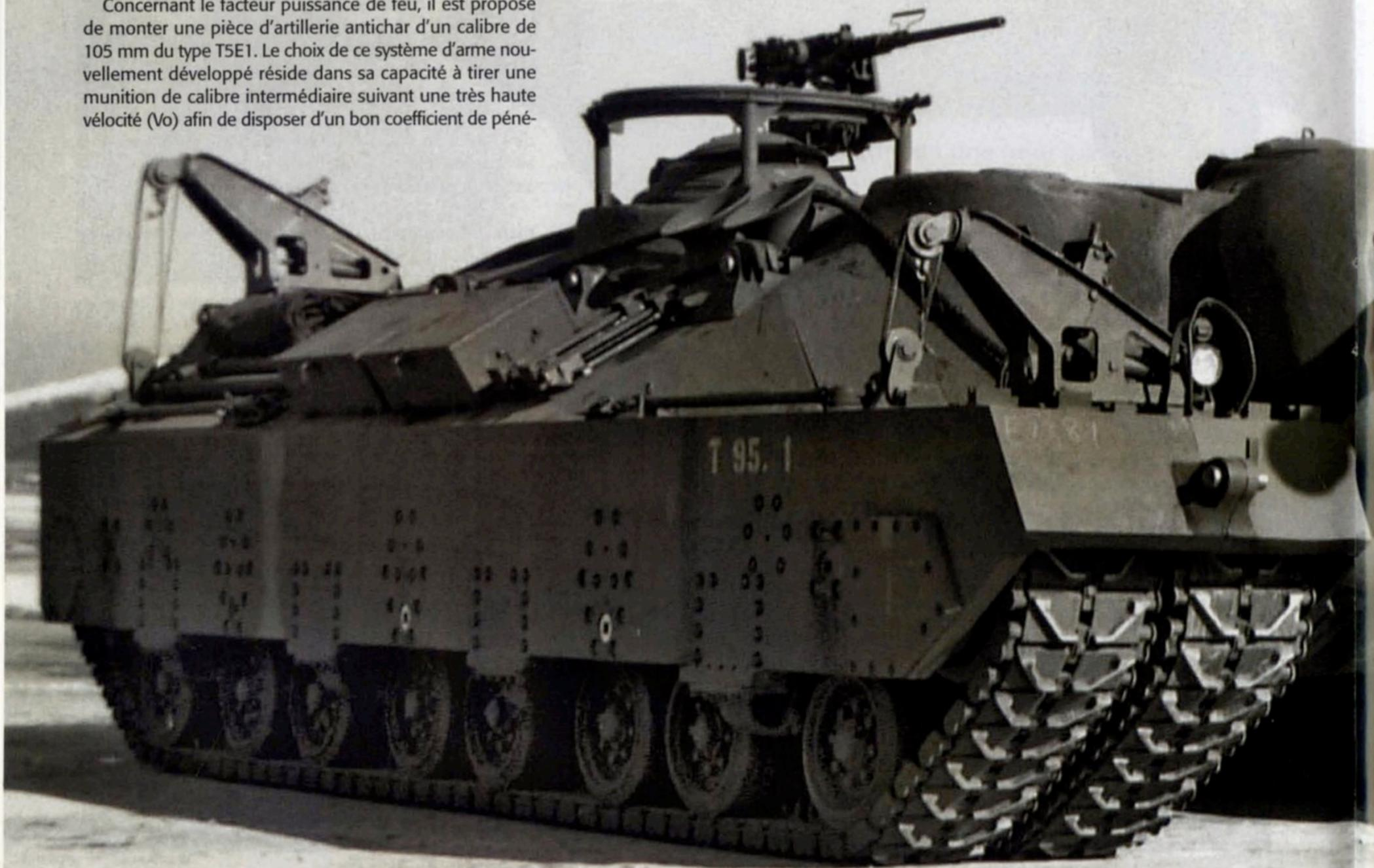
moteur dont l'artillerie principale serait montée très bas, dans la partie frontale de la superstructure de la caisse. Cette option va induire une baisse sensible de la hauteur totale effective et, par conséquent, sa masse totale en ordre de combat, tout en simplifiant sa construction.
