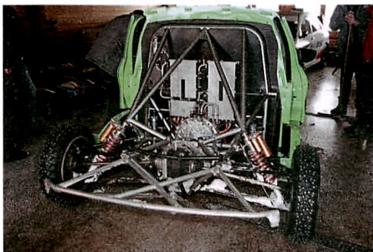
An beiden Achsen ist mittig je ein Elektromotor eingebaut
