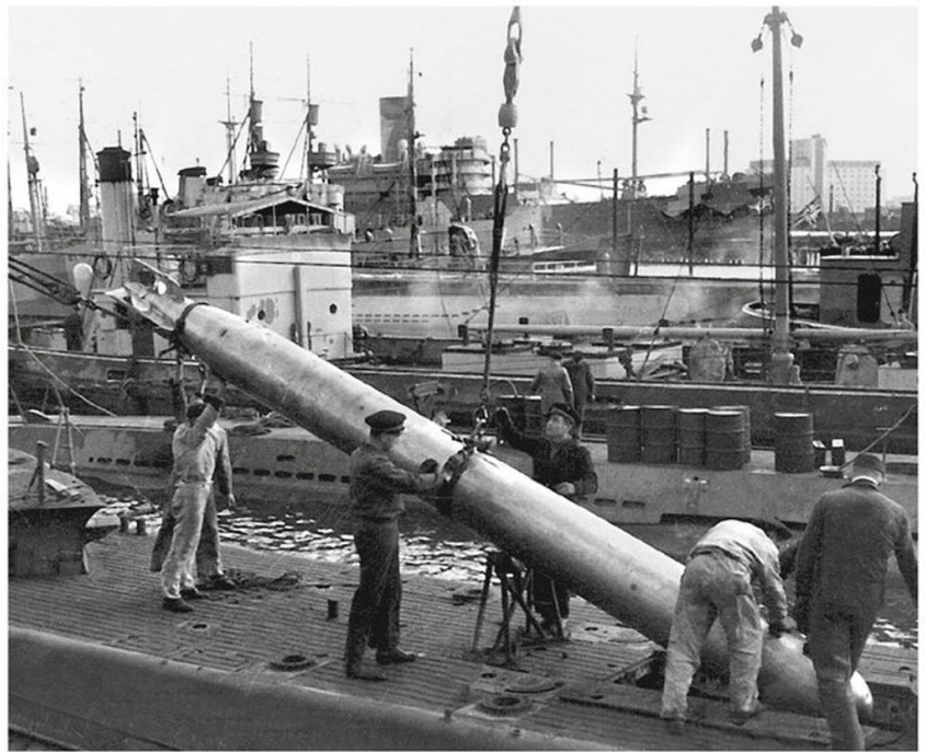
▲ Une manœuvre délicate et laborieuse, ici dans le port de Gotenhafen : le chargement des torpilles à bord d'un sous-marin italien, ici peut-être dans un port allemand durant la guerre. DR
