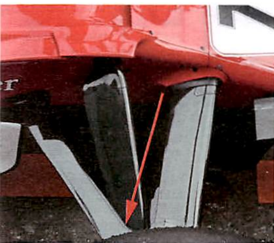
Alte Geometrie: Die oberen Querlenker sind weniger stark gespreizt und zu den unteren leicht versetzt
