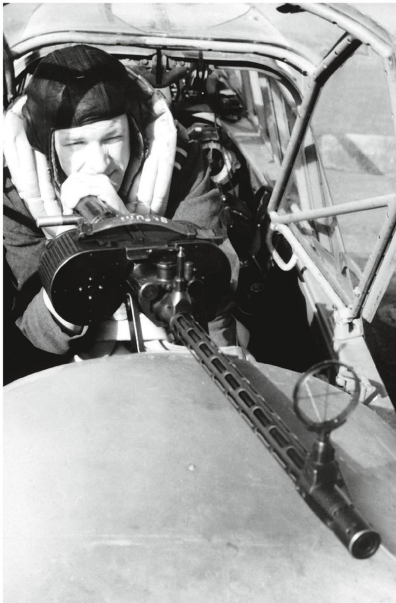
▼ Le poste de tir du Bf 110 C, armé d'une simple MG 15 de 7,92 mm et sans aucune protection pour le mitrailleur. Une défense purement symbolique ! (©ECPAD/France/Photographe inconnu/1942)
