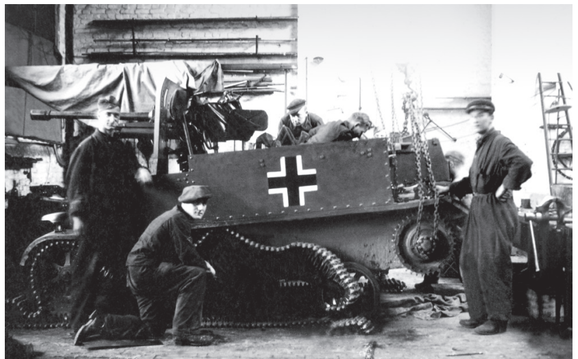
▼ 4,7cm Pak 188(h) auf Selbstfahrlafette Bren(e) en cours de montage dans les ateliers du Baukommando Becker . Ce chasseur de chars a été élaboré avec du matériel de prise : un canon de 47 mm hollandais, mais vendu par une firme allemande, et un châssis anglais d' Universal Carrier . AMC # E021021
