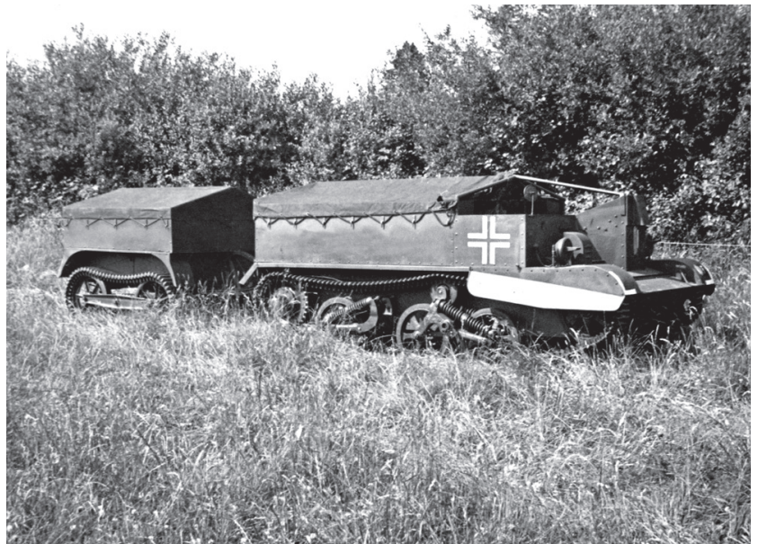
▲ Munitionspanzer auf Fahrgestell Bren-Carrier(e) , une conversion destinée au transport de munitions, vraisemblablement affecté à l' Artillerie-Regiment 227 de la 227. Infanterie-Division . AMC # E022476
