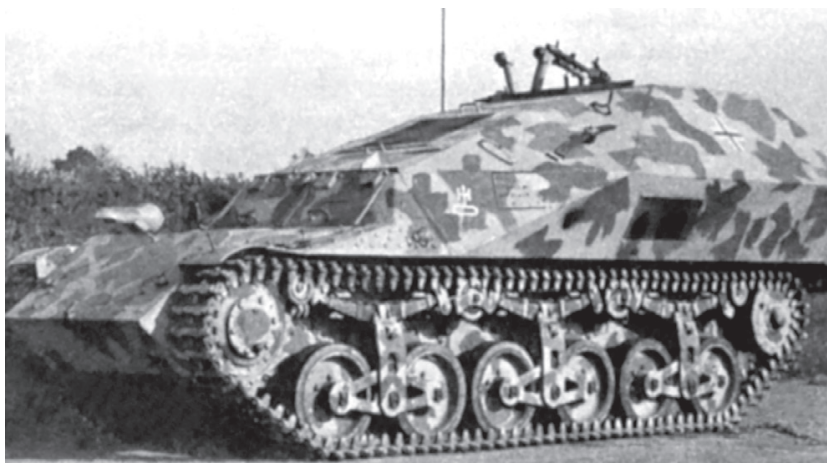
▼ Le char d'observation d'artillerie Beobachtungspanzer auf Lorraine-Schlepper(f) affiche une silhouette assez moderne, avec ses plaques de blindage profilées.
