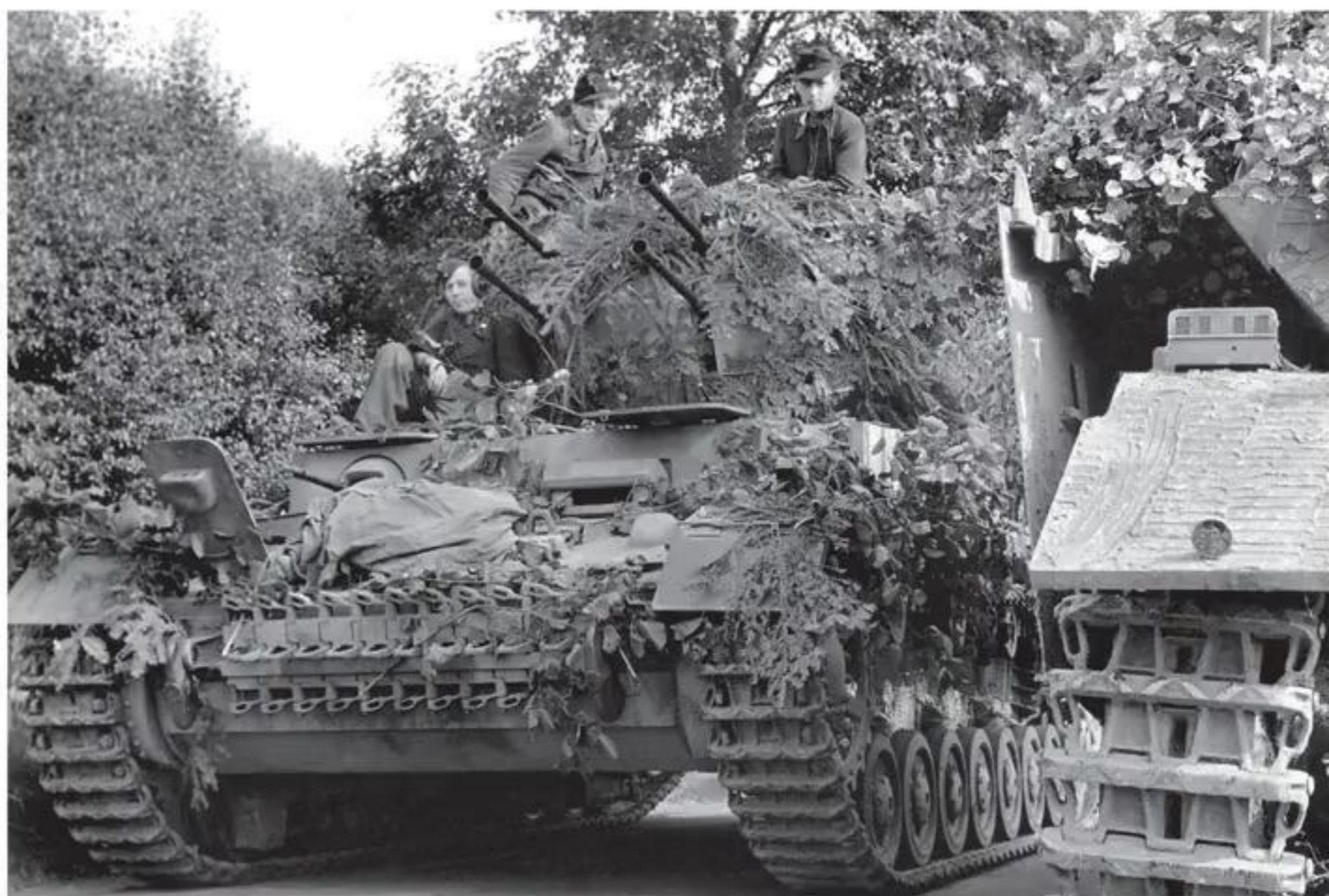
▲ Flakpanzer IV « Wirbelwind » équipé d'un affût quadruple de 2cm Flakvierling . La Flak est une arme essentielle à la Panzerwaffe en septembre 1944, presque autant qu'une mauvaise météo, face à l'écrasante supériorité aérienne alliée. ©ECPAD/France/1944/Scheck
