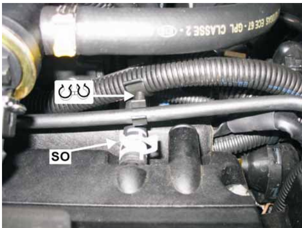
Fig.29 - cablaggio diretto al rail iniettori / tubo originale. rif. "SO" tubo sfiato olio su coperchio valvole motore.
