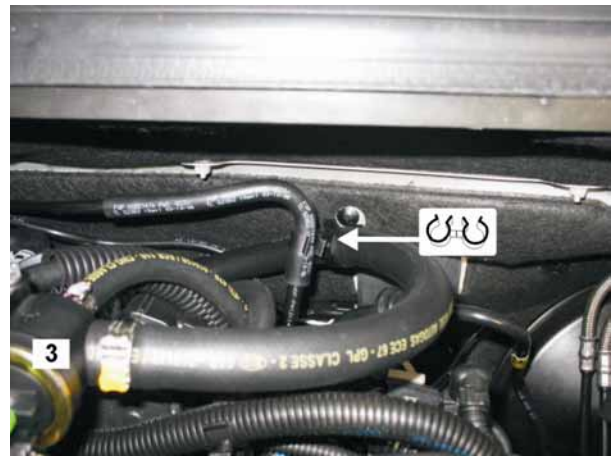
Fig.28 - tubo gas / tubo benzina sulla paratia abitacolo
