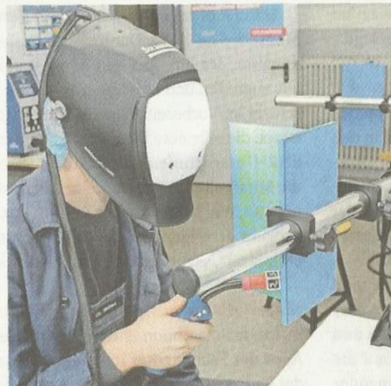
Ein Kursteilnehmer bei der Arbeit: Das Werkstück und der Schweißbrenner sind computeranimiert.
