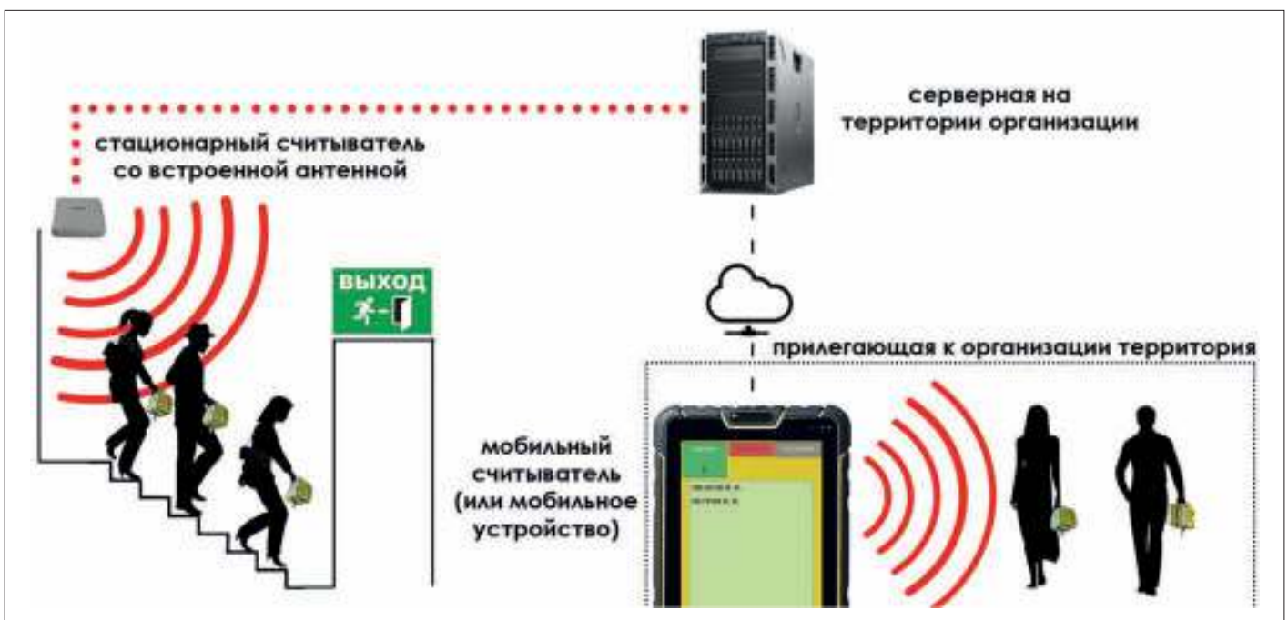
Рис. 1. Способ применения программно-аппаратного комплекса с использованием технологии радиочастотной идентификации
