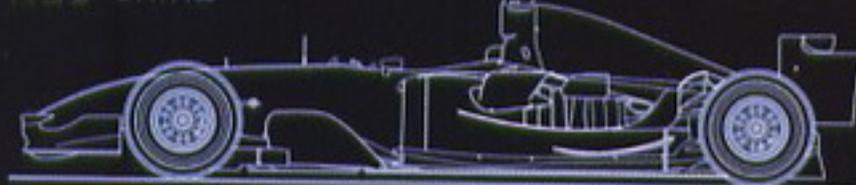
Hace falta ser aerodinamista: nótese los cambios en la deriva del alerón delantero y el trabajo delante de las ruedas traseras
