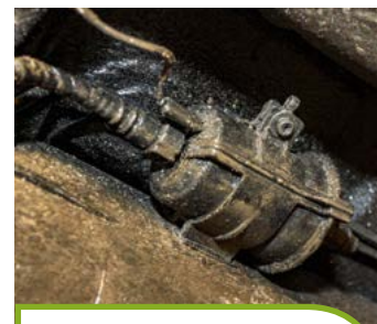
Топливный фильтр на Geely Atlas – подвесной; к тому же он удобно расположен: с доступом к нему проблем не возникает
