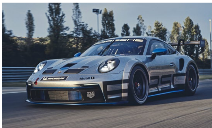
Der Cup-Elfer basiert auf der turbobreiten Karosserie, hat aber einen Sauger
