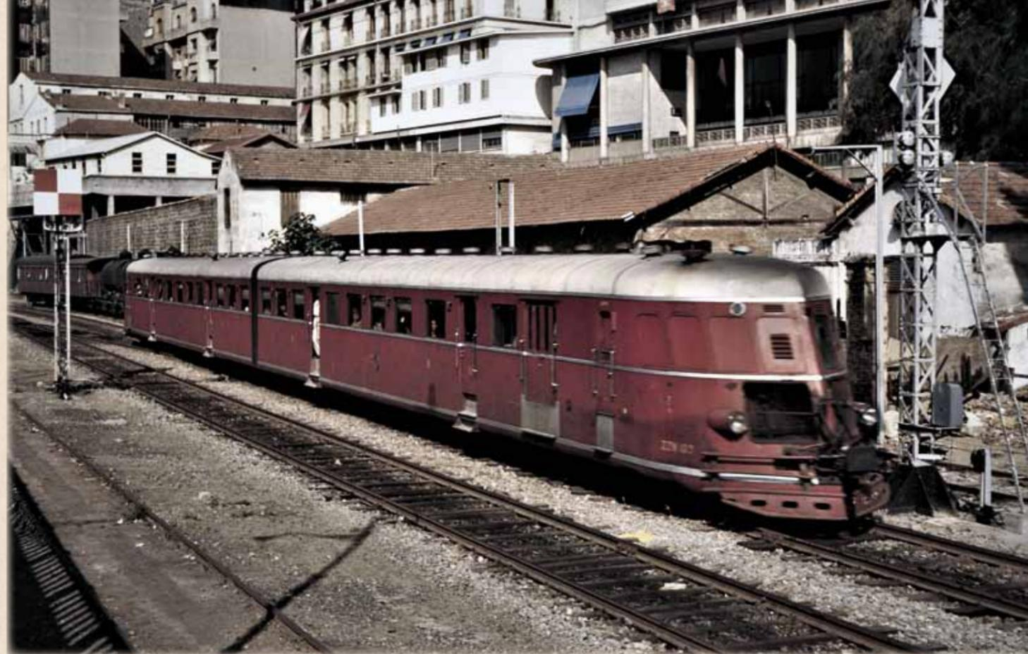
équipés d'attelages Willison, comme les matériels d'avant-guerre, alors qu'à la SNCF, les temps étaient au remplacement de ces équipements par les organes de choc et de traction standard, sur la quasi-totalité des engins de même catégorie (types «320 ch» et XD 3000 ex-gazogène). Appelés «autorails géants» par leur constructeur, les ZZN 101 à 112 furent plus connus sous les surnoms de «Coca-Cola» ou de «Soubressade» dans le milieu che-
