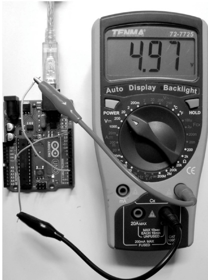
Rysunek 6.3. Złącze cyfrowe działające w trybie HIGH
