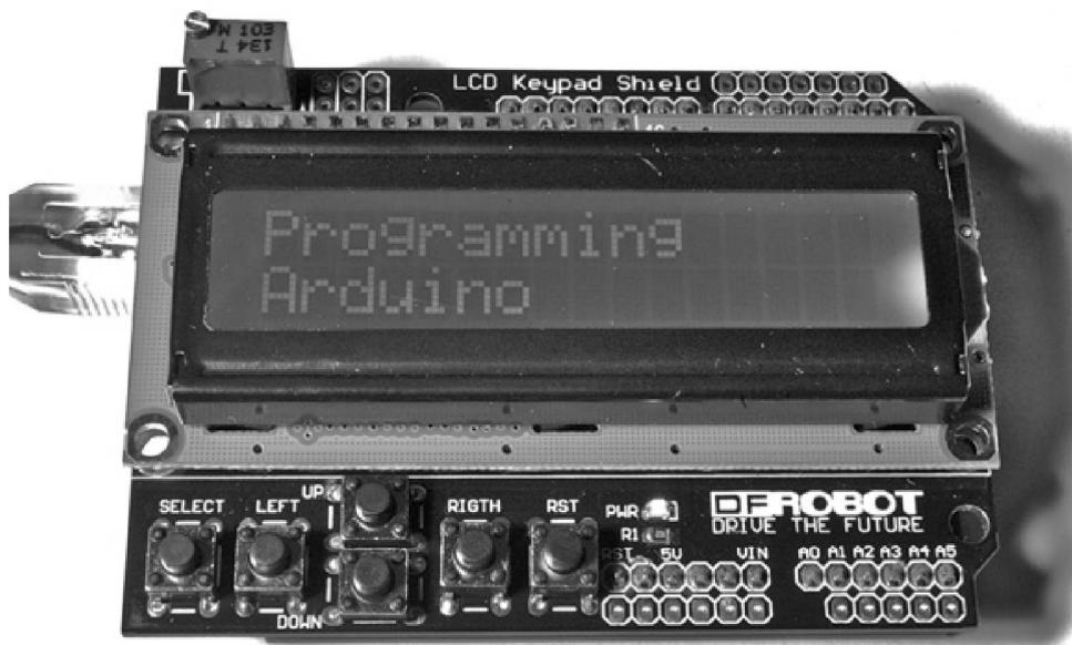
Rysunek 9.2. Płytkę wyświetlacza założona na płytkę Arduino
