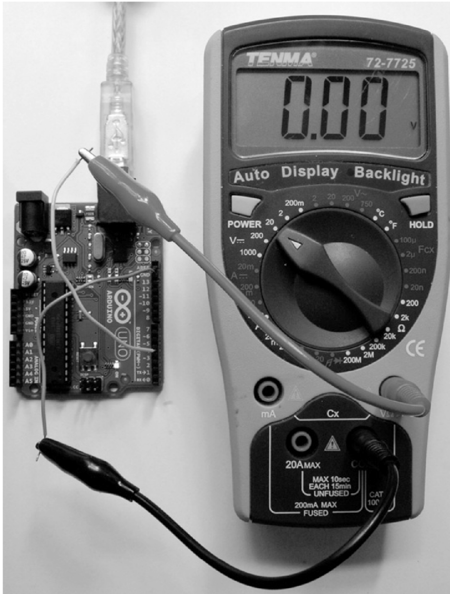
Rysunek 6.1. Stosowanie multimetru do pomiarów na złączach Arduino
