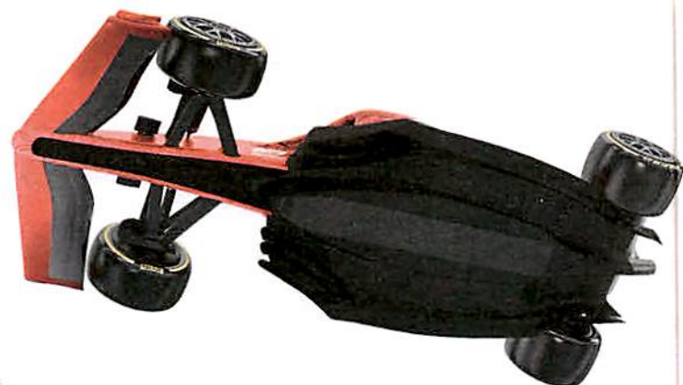
Durch die Kanäle im Unterboden wird das Auto auf den Asphalt gesaugt
