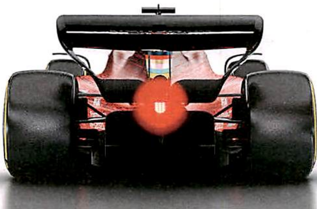
Beim Heckflügel sind oben die Endplatten gekappt. Der Diffusor wird größer
