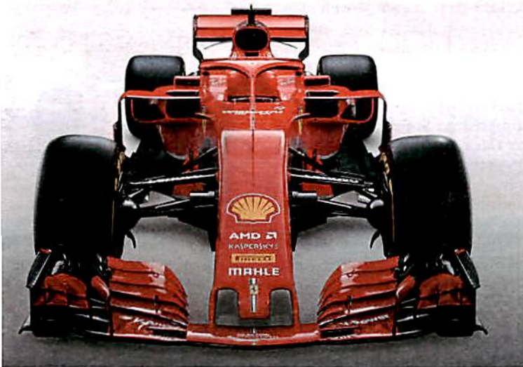
Ferrari SF71H: Längerer Radstand, aggressives Packaging, Halo mit Dach
