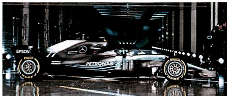
Der Radstand blieb genauso lang wie 2017. Die Anstellung ist etwas steiler
