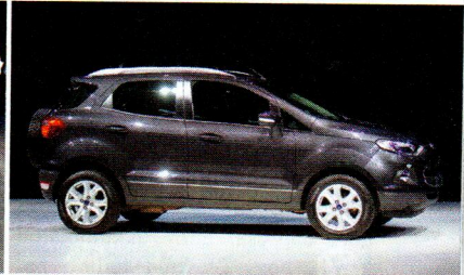
Kívül hordja a pótkerekét az EcoSport SUV, hogy a csomagter elfogadható méretű maradjon
