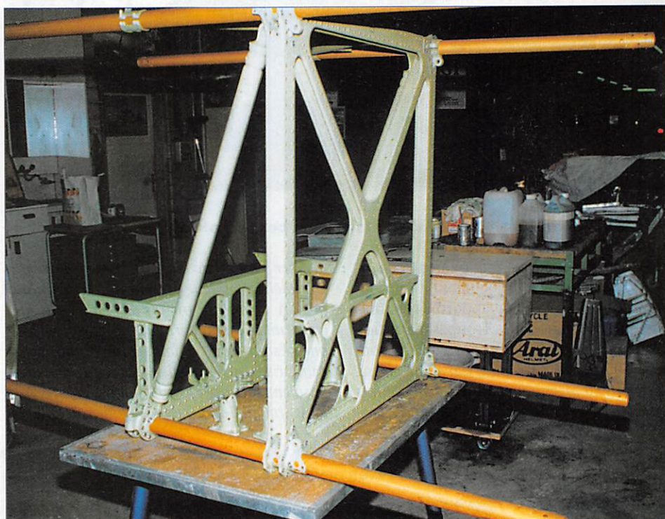
Les débuts de la restauration du fuselage. Les quatre longerons en tube, sciés et corrodés, furent changés, mais les cadres en aluminium, recouverts de zinchromate verdâtre, furent conservés après avoir été nettoyés et traités.
