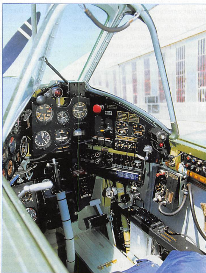
Le poste de pilotage, typiquement français, avec les trois facettes de la planche de bord. Certains instruments pour contrôler le moteur, ses pressions et ses températures, ont un cadran de couleur. Sous ces derniers, le robinet d'essence (horizontal) et le levier commandant le volet du radiateur. En rouge, à droite, en haut de la planche de bord, le bouton du démarreur qu'il faut tirer pour envoyer de l'air comprimé vers les cylindres au point mort haut. (Photos Xavier Méal)
