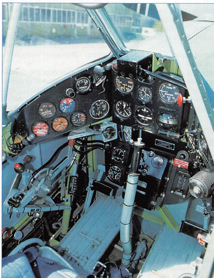
Le poste de pilotage, typiquement français, avec les trois facettes de la planche de bord. Certains instruments pour contrôler le moteur, ses pressions et ses températures, ont un cadran de couleur. Sous ces derniers, le robinet d'essence (horizontal) et le levier commandant le volet du radiateur. En rouge, à droite, en haut de la planche de bord, le bouton du démarreur qu'il faut tirer pour envoyer de l'air comprimé vers les cylindres au point mort haut. (Photos Xavier Méal)
