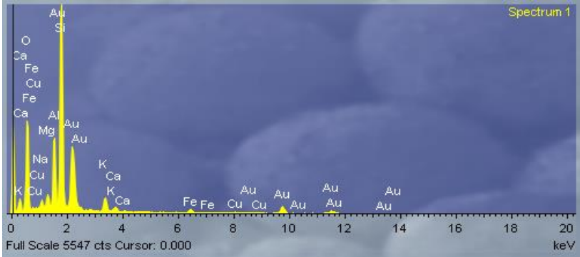
SEM микрофотографија узорка суспендованих честица са EDX спектром елемената у води Градске реке пре улива у Власину; прва мерна тачка у узорку
