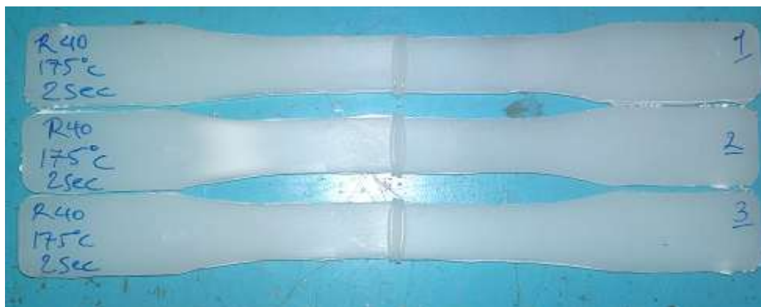
شکل ۱- نمونه جوش‌خورده برای اندازه‌گیری استحکام جوش
