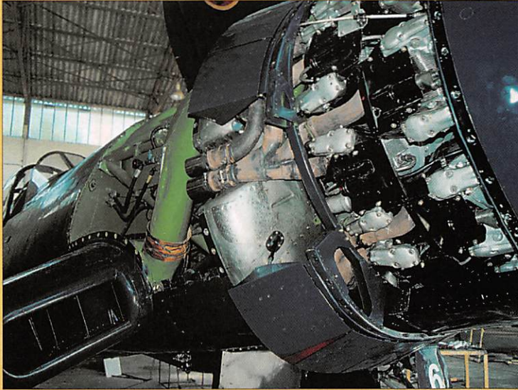
Le moteur partiellement décapoté d'un F4U-7. Le compresseur occupe la plus grande partie de l'espace entre le moteur et la cloison pare-feu. Photo Claude Requi
