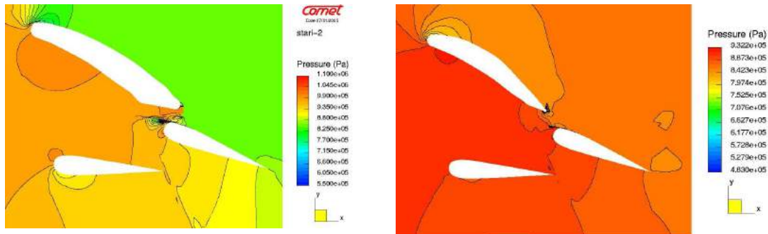
Slika 6. Polje pritiska za stari profil (lijevo) i polje pritiska za novi profil (desno)- Slučaj (1)
