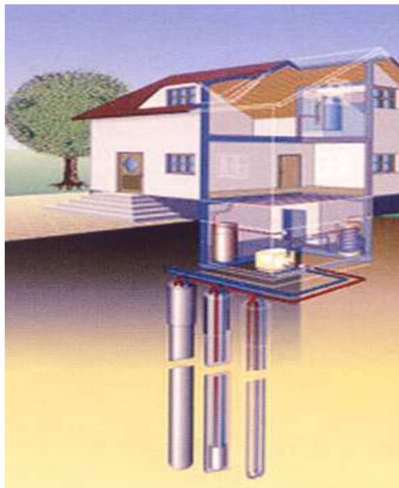
Slika 5. Princip rada toplotne pumpe sa vertikalno postavljenim sondama u zemlji.
