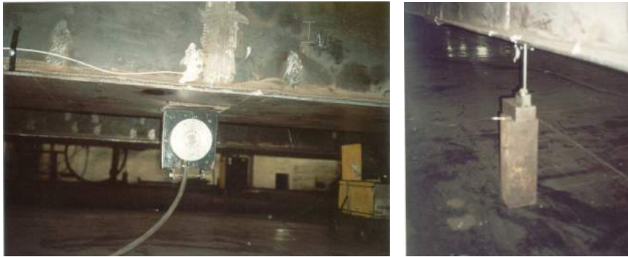
Slika 6. Položaj vibratora na donjoj lameli. Mjerenje amplitude komparatorom.
