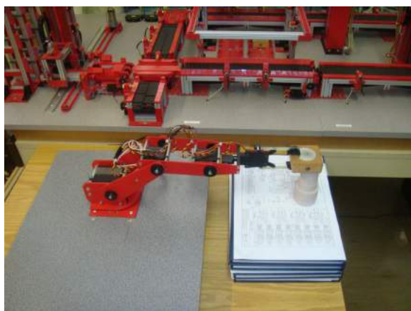
Slika 5. Preuzimanje komada i prenošenje na konvejer
