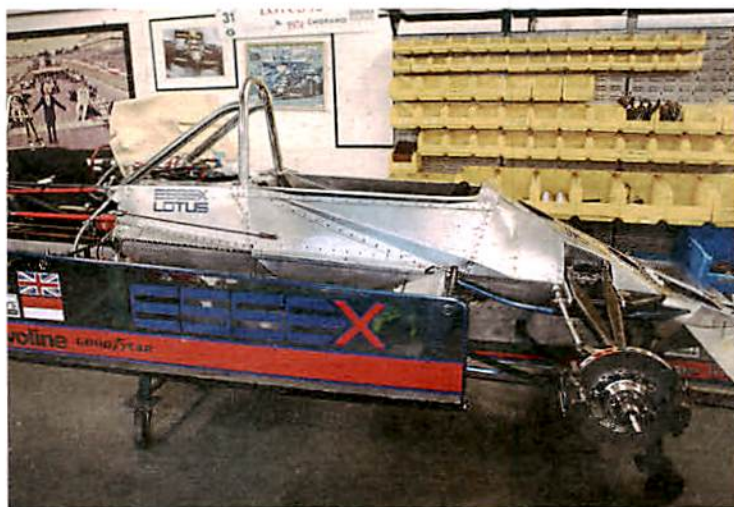
Der Typ 81 von 1980/81 baute als letzter Lotus auf einem Alu-Chassis auf
