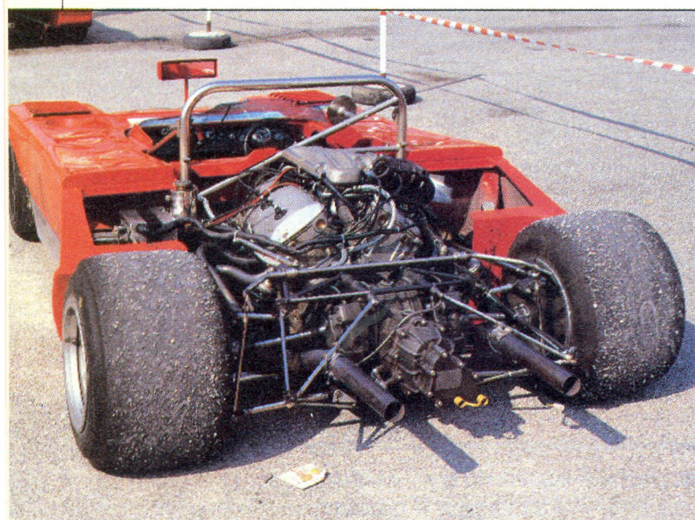
Esteriormente, come si vede nella foto a fianco, le sport nazionali non si discostano dagli esemplari conosciuti. Le novità stanno nel motore che si adatta bene sia su telai Chevron, sopra, sia Osella, sotto. La potenza è di 170 cavalli
