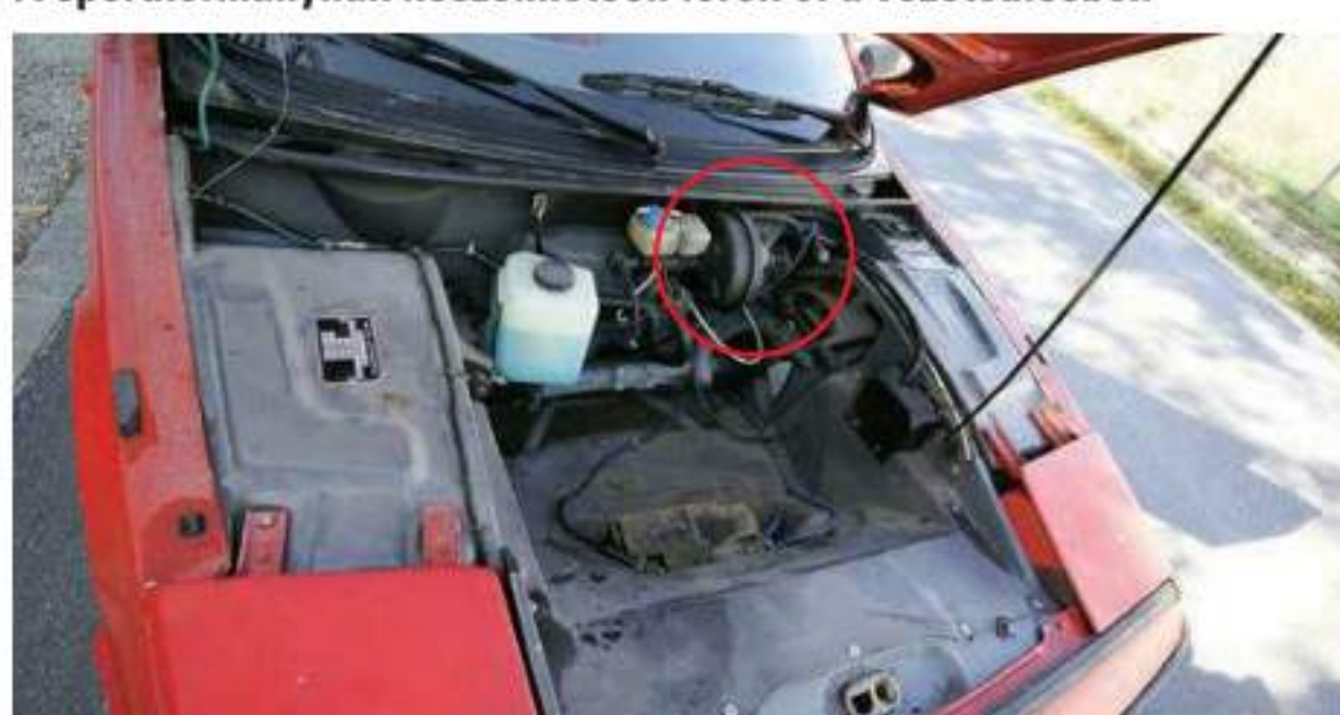
Menetiránynak keresztbefordított főfékhenger – már cserélni kellett
