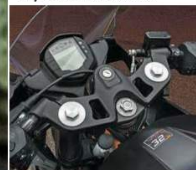
Könnyített villanyak, apró plexi és LCD műszeregység
