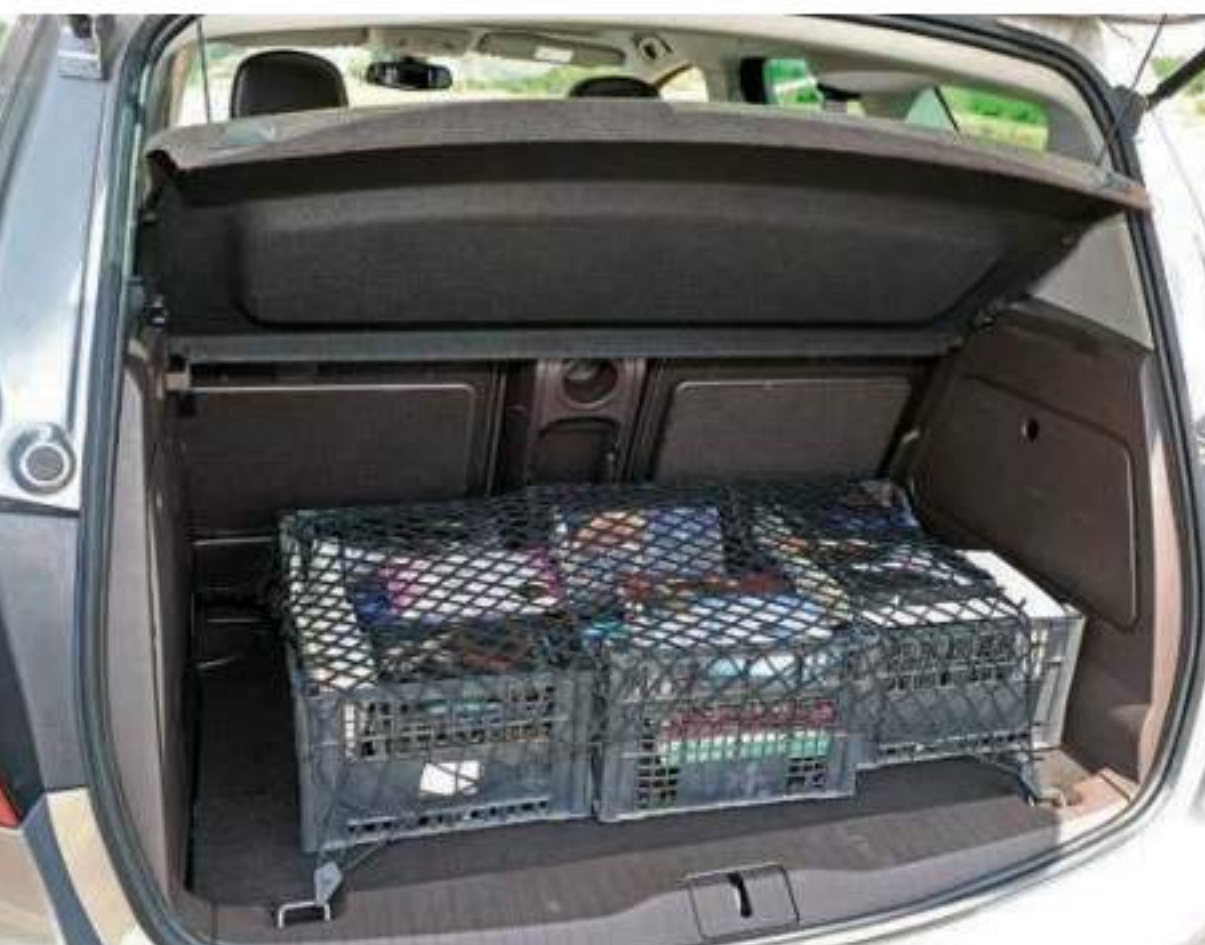
Igy néz ki egy 400 literes csomagtér, a terhelhetőség 612 kilogramm. A rögzítőháló praktikus tétel, könnyű vele a poggyászatot fixálni
