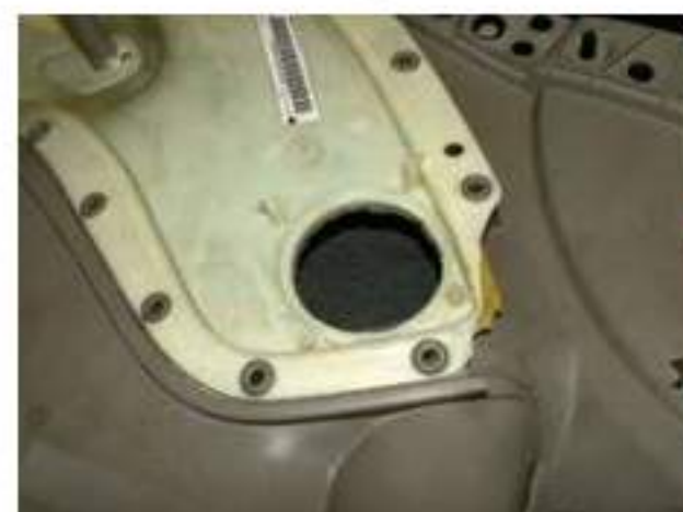
Az ajtókárpiton lévő vakfészkek lett kivágvá a középsugárzónak
