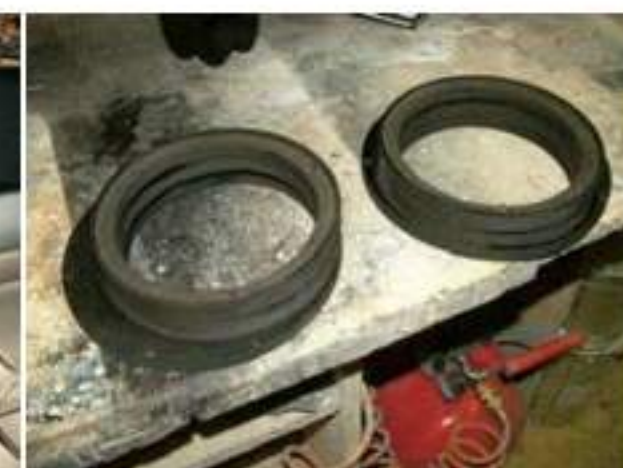
Egyedileg készített hangszóró-peremek a beépítéshez
