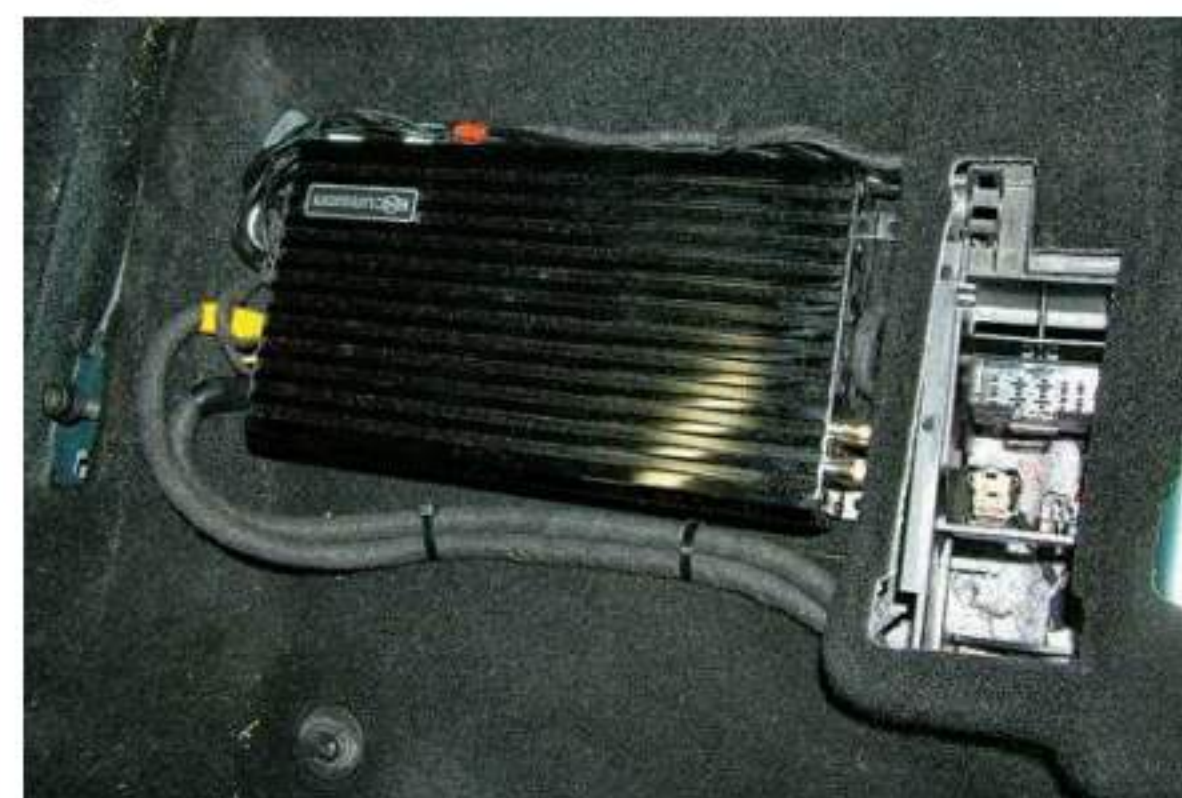
Az erősítő fészke az ülés alatt. Minimális átalakítással szerelték be
