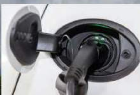
Elektromos töltőnyílás a vezetőoldalon. LED-ek jelzik a töltést
