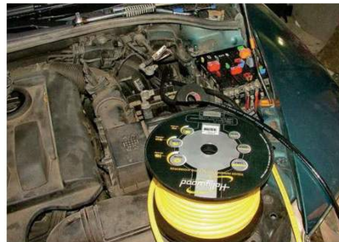
A tápkabelek behúzása az erősítő számára a motortérből
