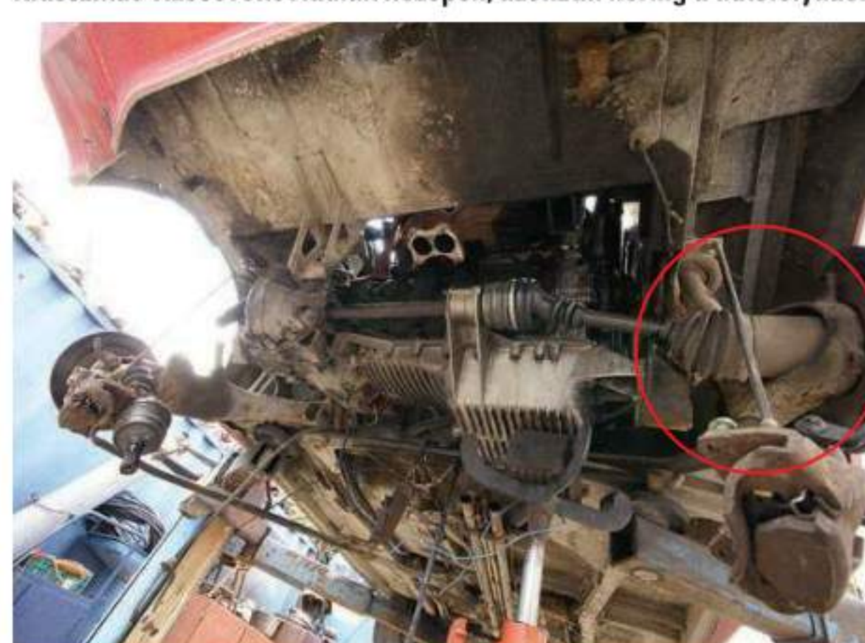
Ez az összerohadt csatlakozás akadályozza a motor leengedését
