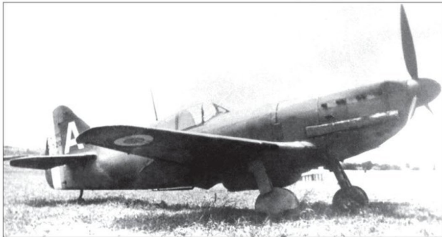
▲ Le n° 31, utilisé pour des tests d'armement, devait être équipé de trois mitrailleuses par aile. En raison du manque de place pour loger les bandes de la troisième mitrailleuse, le projet est abandonné. (Collection de l'auteur)
