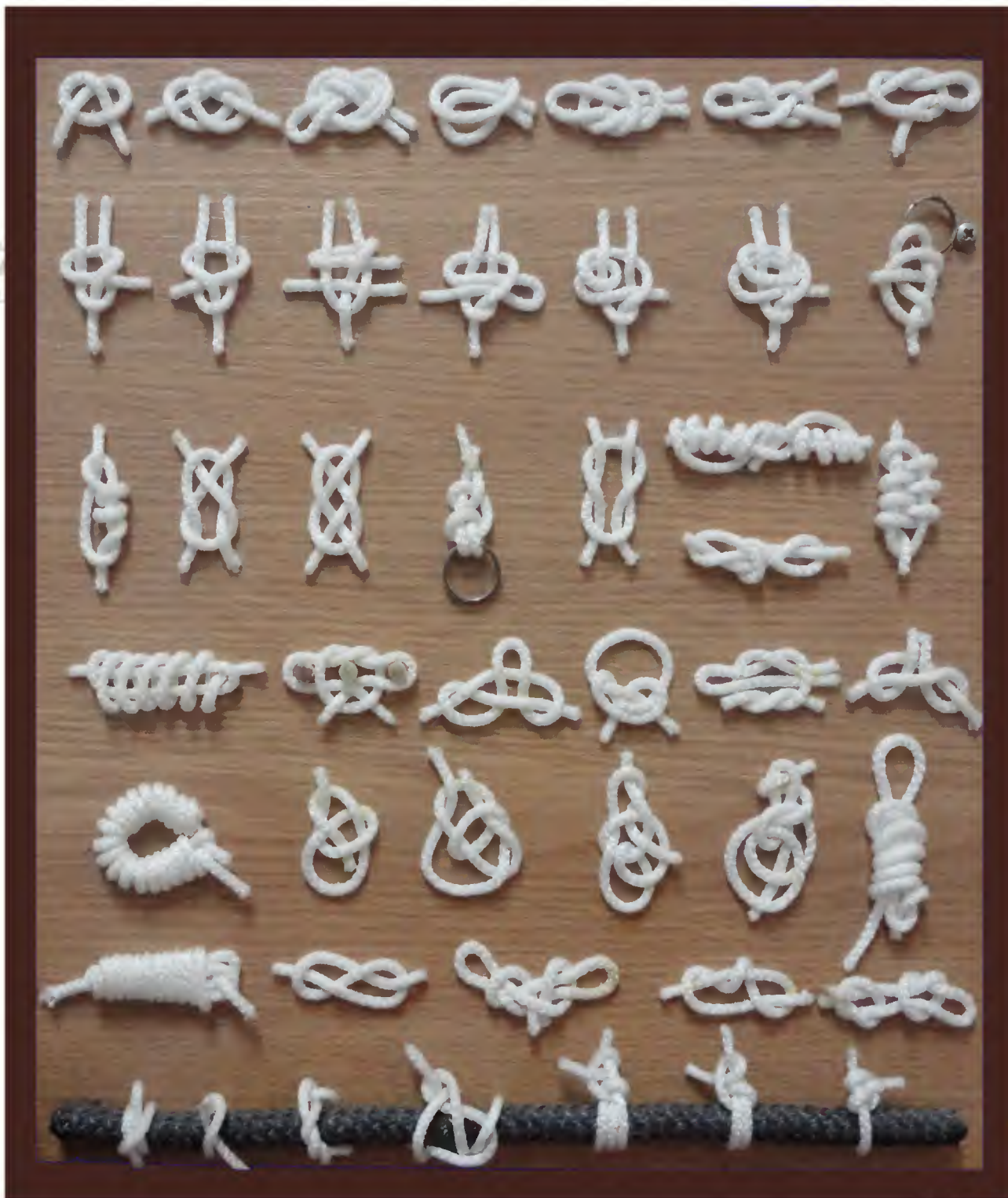
Panoplie cu noduri folosită pentru examinarea cursanților la sfârșitul Modulului instruirii individuale, specialitatea marinărie
