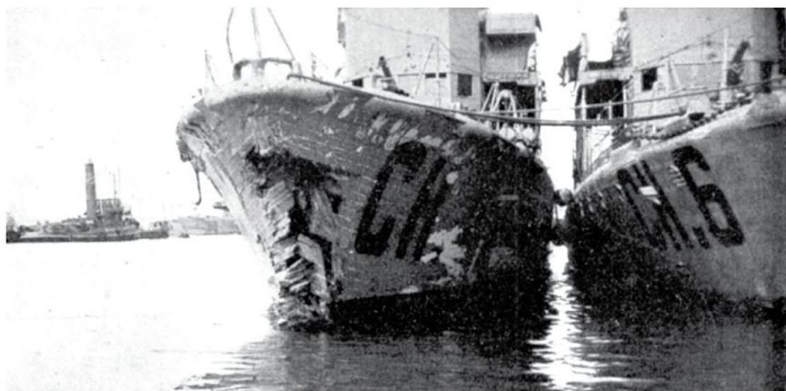
Le *CH 42*, dont l'étrave a été arrachée par une collision avec un tender, à couple du *CH 6*. (DR)
