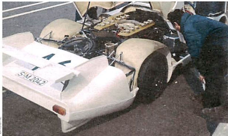
Aerodynamik-Test: Finnen an der Heckunterseite von Herrmanns 917
