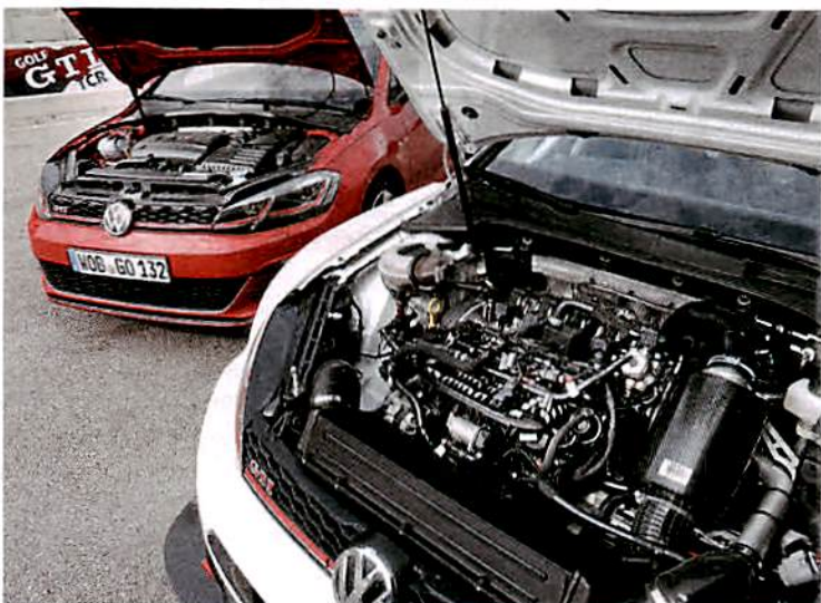
Motor: Serien- (links) und Renntriebwerk sind bis hin zum Turbo identisch
