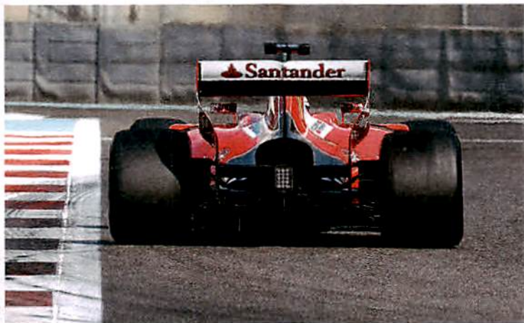
Ferraris Testträger auf Basis des SF15-T mit 2017er-Heckflügel
