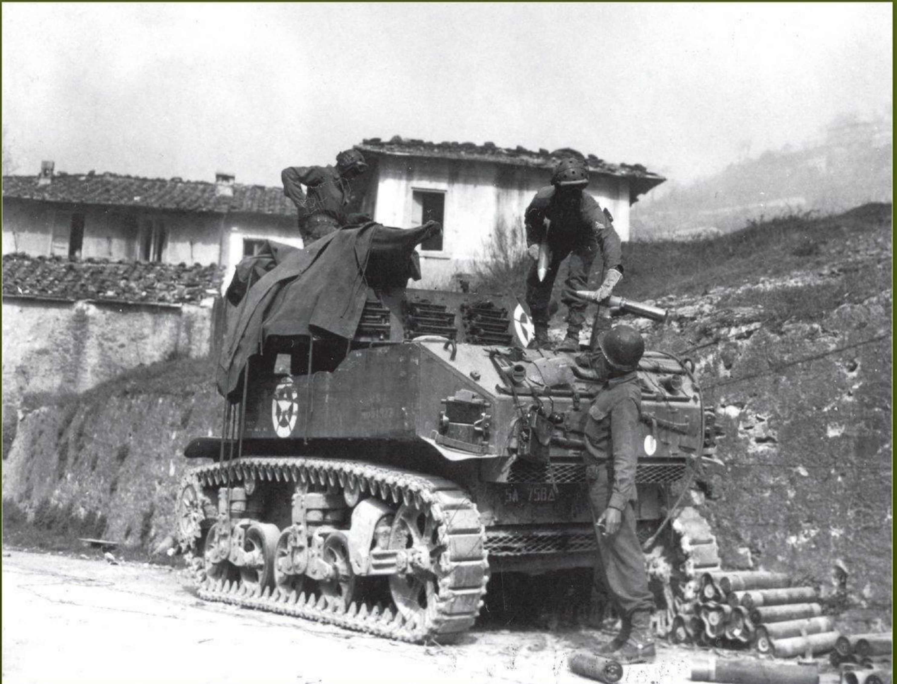
▼ Vue arrière d'un M8 Howitzer Motor Carriage du 758th toujours en pleine action ! L'obusier de 75 mm est fortement sollicité et l'équipage a même constitué une réserve d'obus à côté de l'engin. Le M8 est « plaqué » au muret pour ne laisser dépasser que sa tourelle ; il peut ainsi atteindre des cibles éloignées de plus de 8 kilomètres sans être lui-même repéré.
