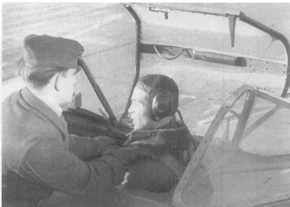
La verrière du Messerschmitt 262 basculait sur le côté, comme celle du Me 109. Cette photo permet d'apprécier la forme complexe de la partie mobile.
