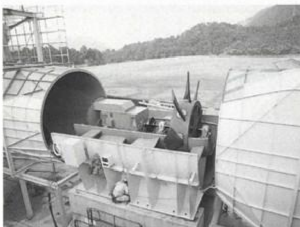
これが特注のモーター。最大風速60m/秒という大容量だけにとにかく大きい
