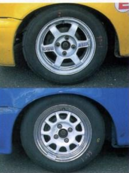
ウィッツの14インチに比べサイズは175/60R13と寂しくなるも、みなSタイヤ。基本的にはブリヂストン、ダンロップ、ヨコハマの3社が覇を競う
