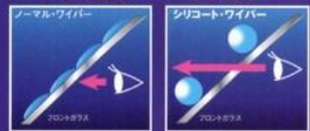
フロントガラスに着いた雨が視界を塞いでしまう フロントガラスに着いた雨を水滴に変え視界を妨げません
