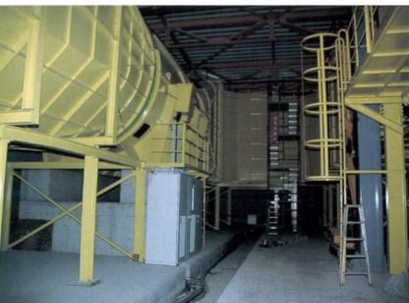
これが建物内部の様子。黄色に塗られた風洞施設は驚くほど大きいものだ。左側にあるのがモーター
