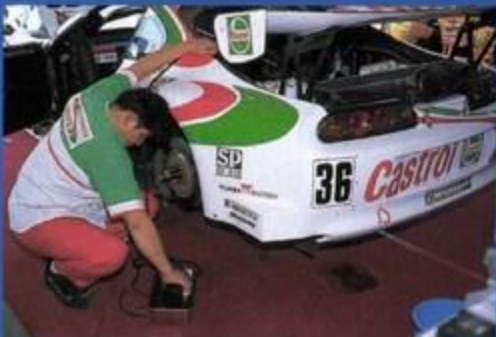
実はレースウイーク中、このような光景は00モデルを走らせるチームで幾度となく見ることが出来る。注入口の位置は各車微妙に異なり、トムスではポンプを使ってタンクに水を送り込む
