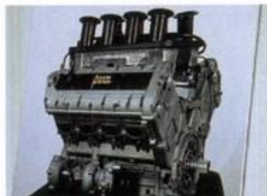
同じV8ながら、排気量6ℓから4ℓへ変更。一気に軽量コンパクトなエンジンへと生まれ変わった
