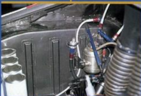
水の注入口は、確かに怪しげな雰囲気をもちながらマシン後部に存在。しかし作りそのものは簡素なため、ウォーターインジェクションの存在を知らないかぎりとても重要なものとは思えない
