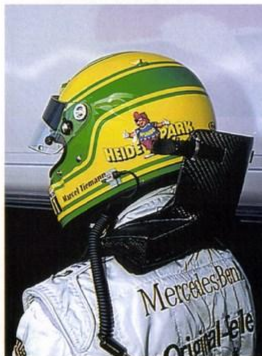
これがHANSシステムを後ろから見た図。首の後ろの部分が特にサポートされているのがよく分かる。上部はヘルメットに付いている
