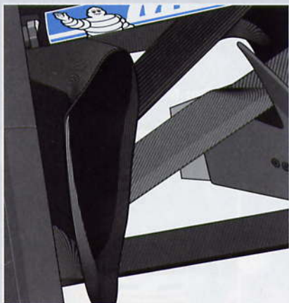
El diseño de los conductos de frenos del Williams FW25 trata de limitar la resistencia aerodinámica.
