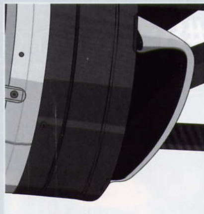
El diseño de Ferrari parece rechoncho. Los discos están sellados, lo que aumenta el recalentamiento.
