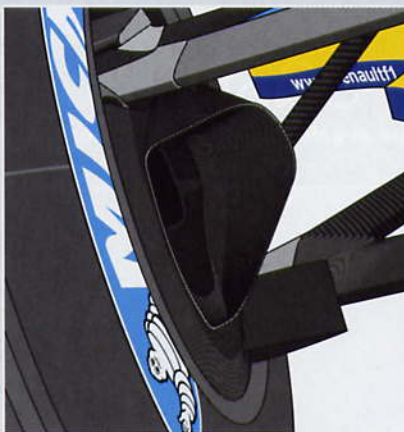
Renault usa dos conductos, como McLaren. Uno para el disco y las pastillas; el otro para la pinza.
