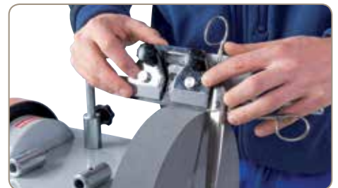
05-2055 Sciccors jig: Ideal for sciccors or secateurs
