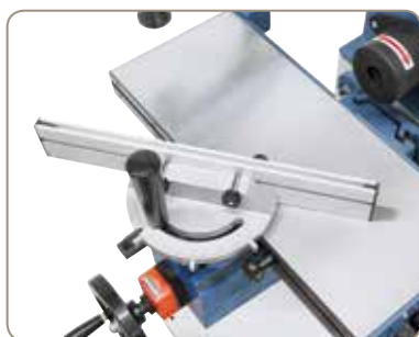
Adjustable mitre fence, tiltable 2 x 60°.
