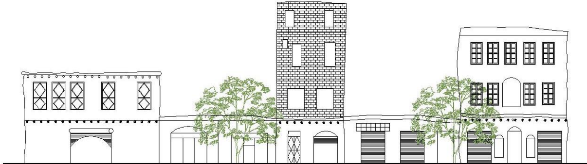
الشكل [9-2]: جزء من واجهات محور الحج وتبدو فيها تداخل الابنية الحديثة مع القديمة والفروق بعدد الارتفاعات. المصدر: الباحثة.
