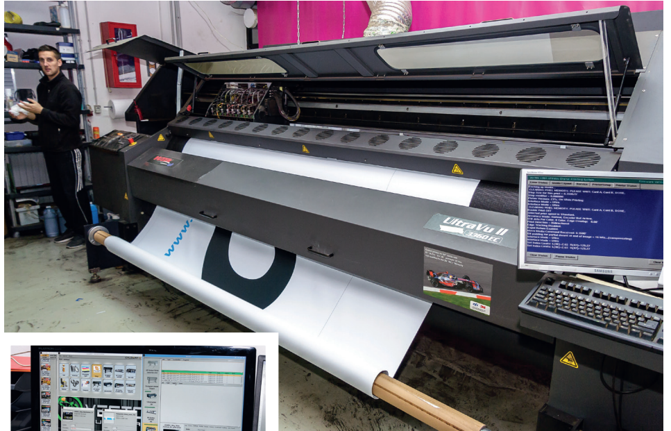
DUO FANTASTIKUS Printer Vutek od proizvođača koji je pionir velikih formata sa širinom ispisa od 3,2 metra u kombinaciji s odličnim Caldera RIP softverom
