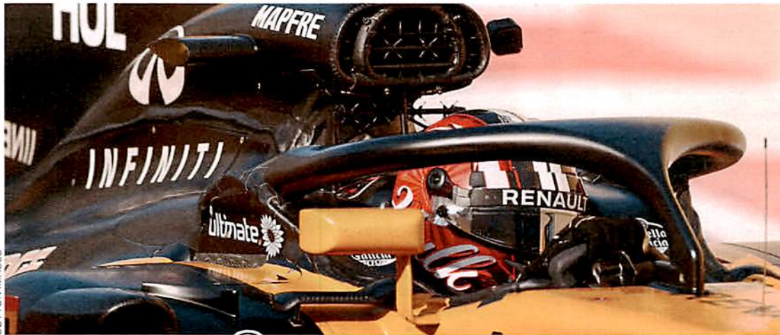
Der Halo sorgt 2018 für zusätzliche Kilos im Auto. Groß gewachsene Fahrer können das Gewicht nicht ausgleichen
