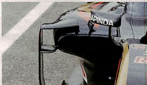
Toro Rosso: Gebogene Leitbleche am Seitenkasten
