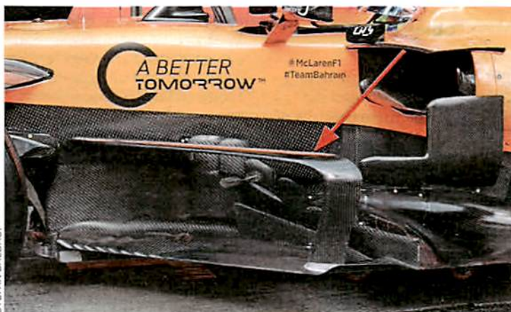
Der innovative Bügelflügel am McLaren hielt bei den Tests nicht lange fest
