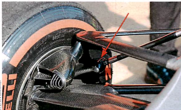
Die Mercedes-Schubstabe ist über einen Steg am Radträger befestigt
