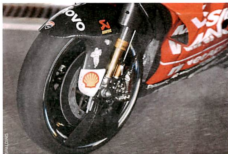
Ducati: Passend zur Schaufel an der Schwinge eine Lufthutze an der Gabel
