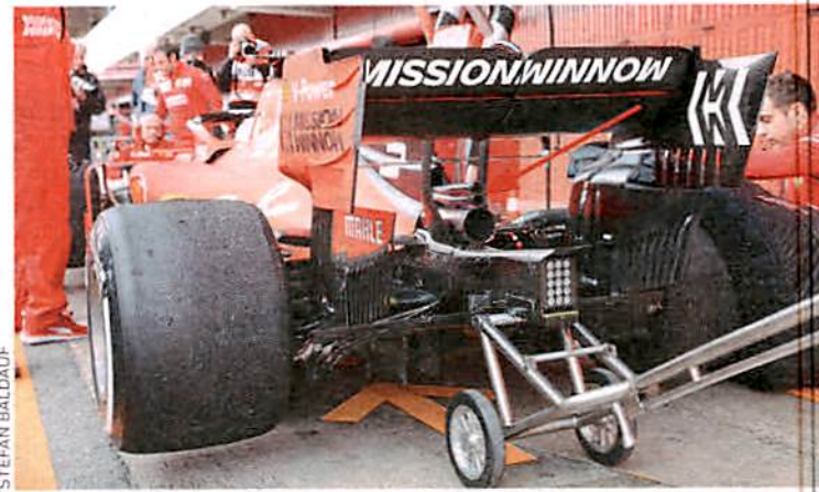
Auch dank der gestapelten Wastegate-Rohre baut Ferrari im Heck schmal
