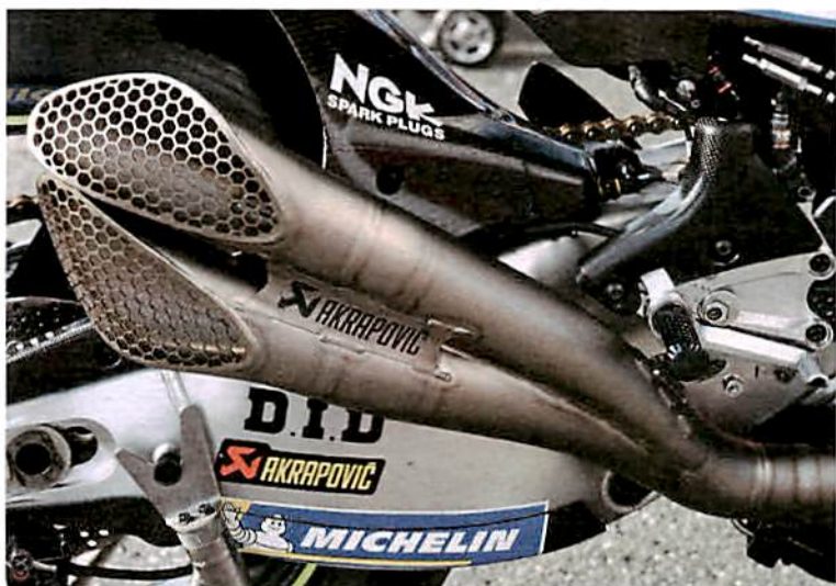
Suzuki: Doppelauspuff für den Reihenvierzylinder nach Moto2-Vorbild
