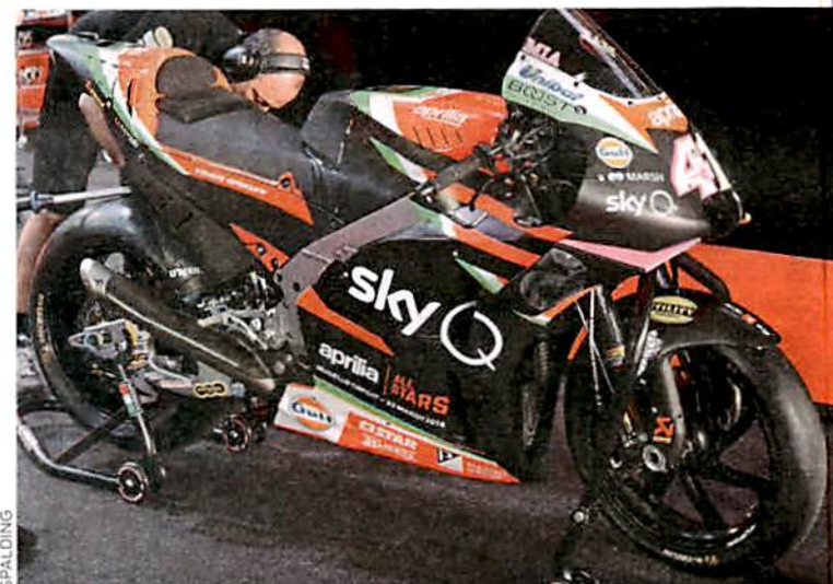
Aprilia: Neue Lackierung und Motorvariante mit längerem Auspuff
