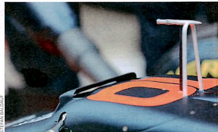
Der Luftkanal auf der Red-Bull-Frontpartie unterschützt den S-Schacht
