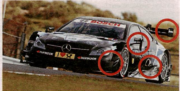
Mercedes neu (oben) und alt (unten): Front-Flips, Seitenschweller, Rückspiegel und Heckflügel aerodynamisch verfeinert – in Zandvoort erst nur am AMG-C-Coupé von Christian Vietoris
