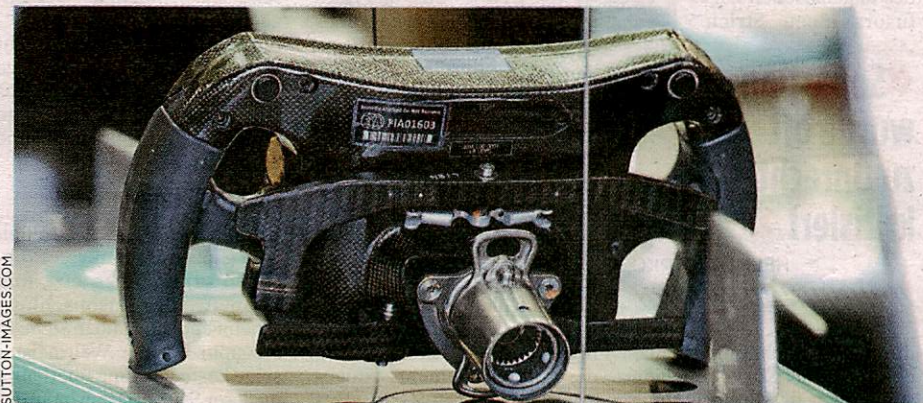
Rosbergs Lenkrad: Nicht daran, sondern in der Lenksäule trat in Singapur ein Defekt auf
