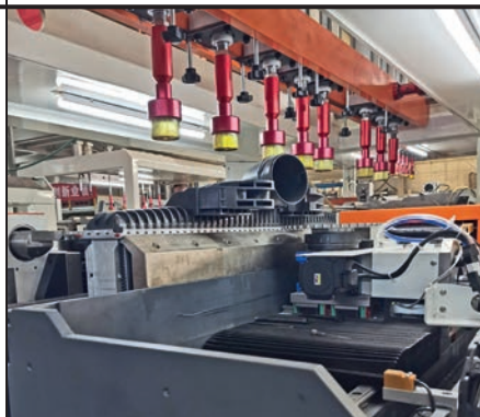
Пластмассовые бачки соединяют с сердцевинной через прокладки
