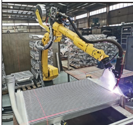
Сварка алюминиевых бачков с сердцевинной роботизирована
