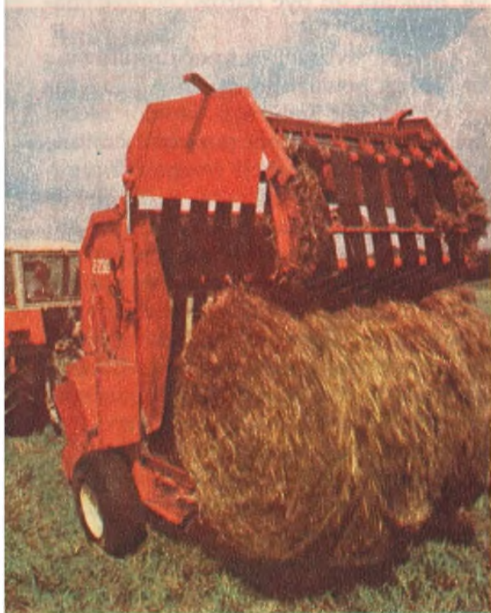
Wystawiane w Brnie przez polską centralę Agromet urządzenia do rolowania siana w bele konkurowało z podobną konstrukcją firmy HESSTON
