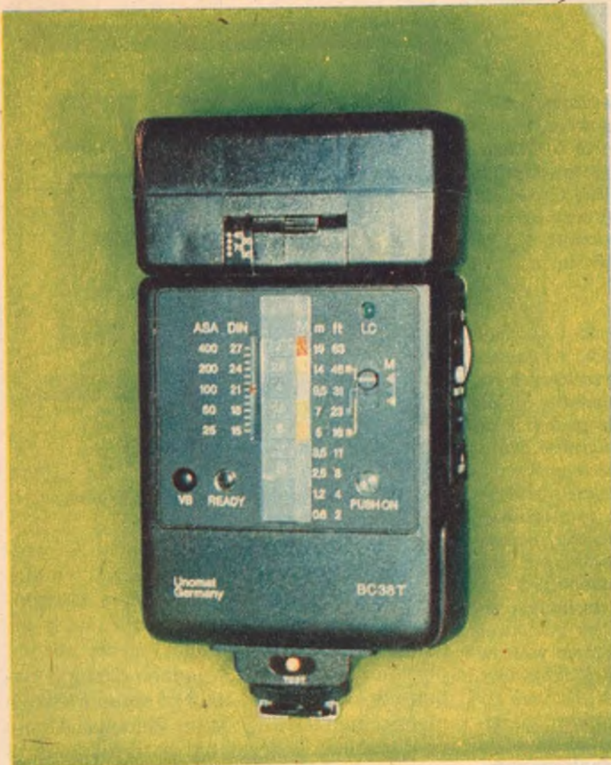
Lampa „UNOMAT” BC 38 T; obok skali przesłon widać zapalony pionowy lańcuszek pięciu kolorowych diod luminiscencyjnych. Dolna świecąca dioda o kolorze pomarańczowym wskazuje wielkość otworu przesłony, który należy nastawić w obiektywie aparatu
