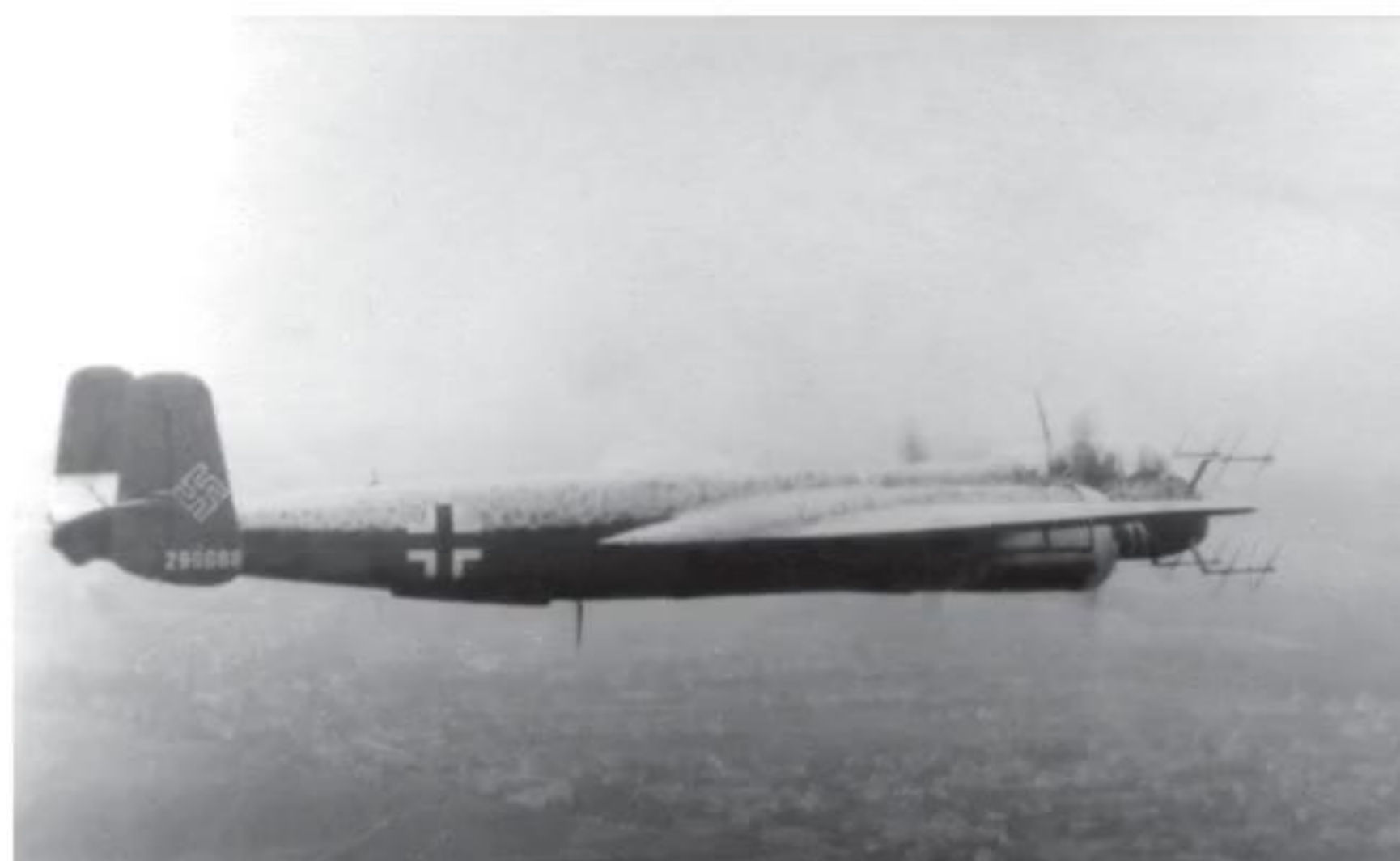
▼ Ce He 219 A2 (WNR. 290 068) du I./NJG 1 porte un camouflage très élaboré, vraisemblablement une base de RLM 75 avec des « gribouillis » en RLM 76. Cette association avec le RLM 22 des surfaces inférieures est plutôt rare, mais la Luftwaffe nous a habitués à des combinaisons inédites. On peut aussi noter les antennes dipôles orientées à 45° pour modifier la polarisation et limiter le brouillage par les contre-mesures alliées. (ww2images.com)
