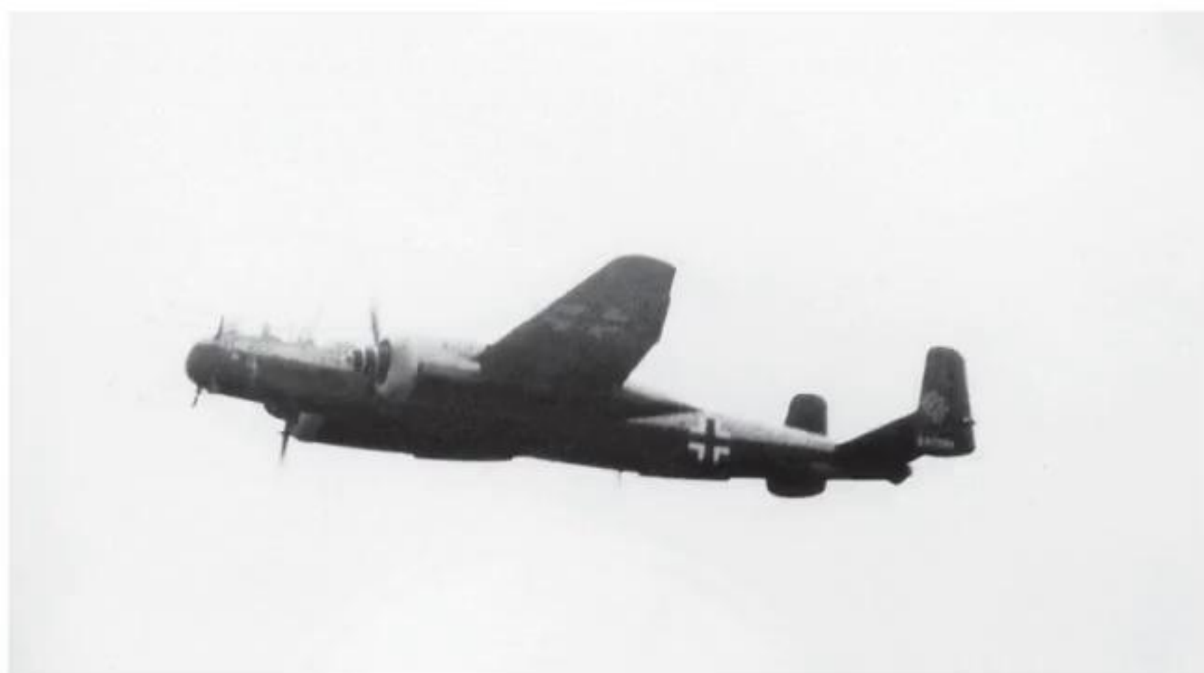
▼ Ce He 219 A2 (WNR. 290 068) du I./NJG 1 porte un camouflage très élaboré, vraisemblablement une base de RLM 75 avec des « gribouillis » en RLM 76. Cette association avec le RLM 22 des surfaces inférieures est plutôt rare, mais la Luftwaffe nous a habitués à des combinaisons inédites. On peut aussi noter les antennes dipôles orientées à 45° pour modifier la polarisation et limiter le brouillage par les contre-mesures alliées. (ww2images.com)
