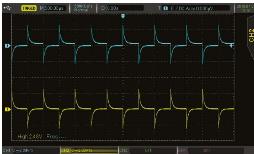
Rysunek 20. Jeżeli obie pary uzwojeń są poza fazą, to mierzony sygnał na kanale 2 jest przesunięty w fazie o 180°.
