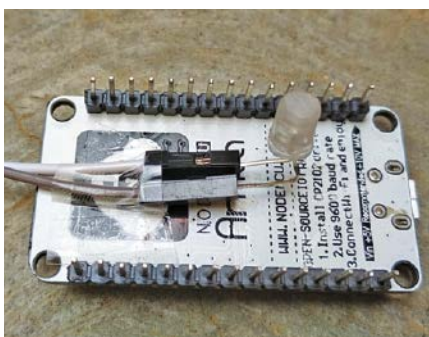
Rysunek 14. NodeMCU i dioda LED umieszczone na dole
