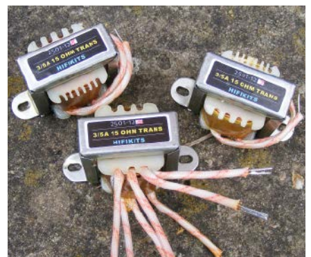
Rysunek 4. Laminowane cewki LS3/5a są dostępne na eBayu. Producent nie podaje, czy zastosowano w nich Radiometal czy stop żelaza z krzemem, ale brzmiały dobrze.
