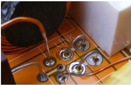
Rysunek 11. Płytkę posiada opcję biwiringu. Jeżeli opcja ta nie jest używana to sekcje niskotonowa i wysokotonowa są połączone jak na rysunku powyżej.
