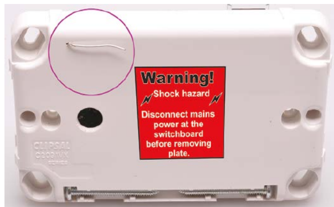
Te trzy zdjęcia pokazują lokalizację i montaż drutu łączącego obwód PCB z wewnętrzną aluminiową płytką dotykową. Przechodzi on przez otwórki w płytce nośnej i w obudowie Clipsal oraz styka się z aluminiową płytką dotykową po jej zatrzasknięciu w obudowie. Uwaga – nie pokazano soczewki Fresnela!
