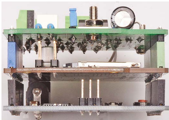
Widoczny jest sposób połączenia wszystkich trzech płytek ze sobą, za pomocą listew kołkowych i jednorzędowych gniazd żeńskich.
