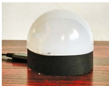
Rysunek 15. Osłona rozpraszająca umieszczona na tekturowej podstawie
