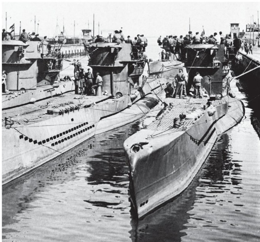
◀ Trois Typ VIIC équipés du Schnorchel à Wilhelmshaven juste avant la fin des combats.
