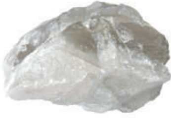
الشكل 2-3 تبلورت هذه القطعة من الكوارتز في حيز محصور ضمن كسر أو شق في الصخر.
